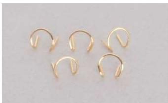
Prüfkörper aus Golddraht
