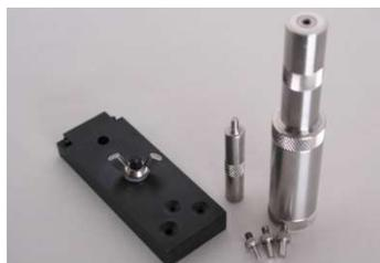
Handpresse zur Herstellung von zylindrischen Probekörpern
