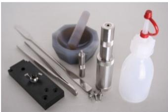
Set zur Herstellung von zylindrischen Probekörpern
