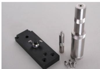
Handpresse zur Herstellung von zylindrischen Probekörpern
